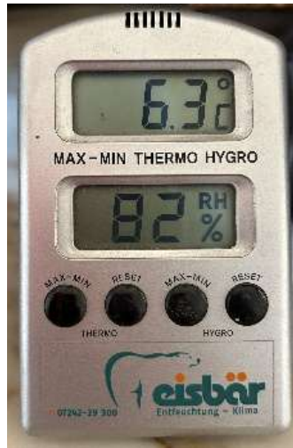
Feuchtigkeit und Temperatur vor dem Lüften.
